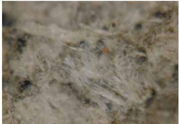
FIGURA 8. Crisotilo (microfotografía de una muestra de la cubierta del Mercado Central, correspondiente a una placa cuadrada de espesor 6 mm).
