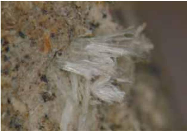
FIGURA 7. Crisotilo (microfotografía de una muestra de la cubierta del Mercado Central, correspondiente a una placa cuadrada de espesor 3 mm).
