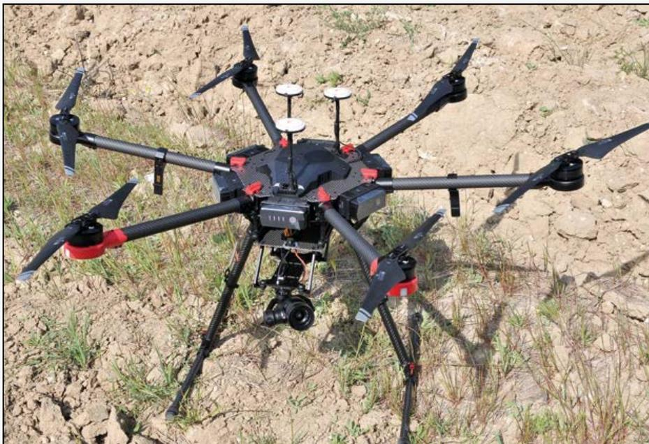
**Figura 2.** Aeronave tripulada remotamente (Remotely Piloted Aircraft o RPA) del CEDEX para la inspección de estructuras.
