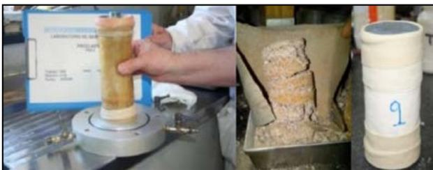
**Figura 26.** Membranas impermeables (izquierda) y tejido tipo hule usado para los ensayos de compresión isotrópica y triaxiales.
