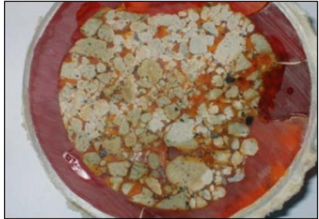
**Figura 18.** Muestra de piroclasto inmersa en resina coloreada para observar mejor su macroestructura.
