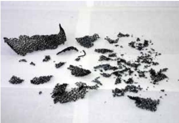
FIGURA 10. Estado de la geostera del rollo 2 tras sus tres ciclos de tratamiento con el hidróxido cálcico.
