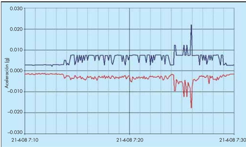
FIGURA 13. Máximos (azul) y mínimos (rojo) obtenidos de muestras de 5 segundos extraídas del parámetro "aceleración en X".
